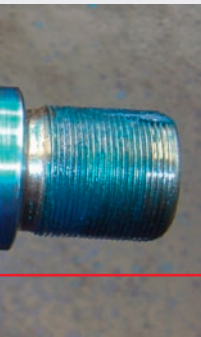
LKW-Achse mit Gleitlackbeschichtung
